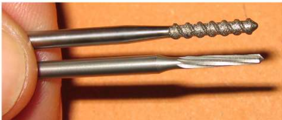
Рис.1. Фреза стальная «...» фирмы «Майзингер» (Германия) для хирургических работ по кости (внизу) и алмазный спеченный винтовой инструмент типа «МонАлиТ» фирмы «Рус-Атлант и Ко» (вверху).
