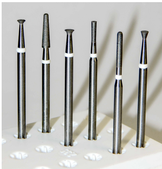
Рис. 1. Набор головок «МонАлиТ-9» с мелким зерном (20–40 микрон) для контурирования окклюзионной поверхности коронок из диоксида циркония
